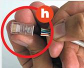
9. Presne el conector con ayuda de unas pinzas ponchadoras de cable UTP. Hacer el mismo procedimiento del otro extremo del cable
