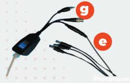
12. Conecte el conector de video del transceptor (g) a una entrada de video del DVR (a1) y el conector de audio a una entrada de audio del DVR (a3)
